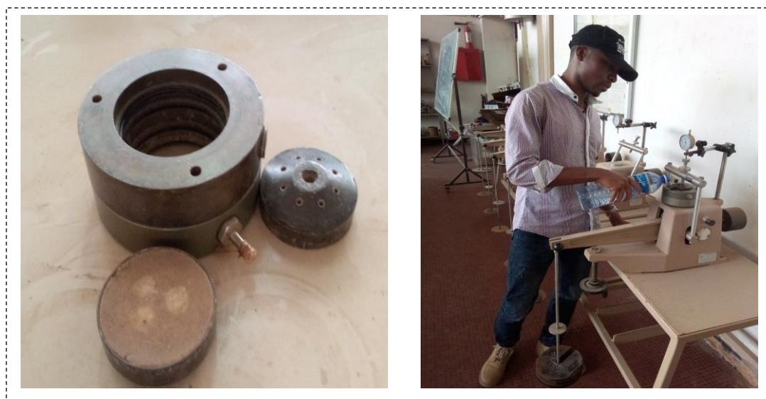
Figure 2-13 : Essai œdométrique (à gauche et à droite)
