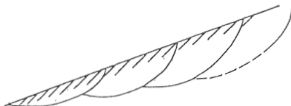
Figure 1-10 : Glissement rotationnel complexe [17]
