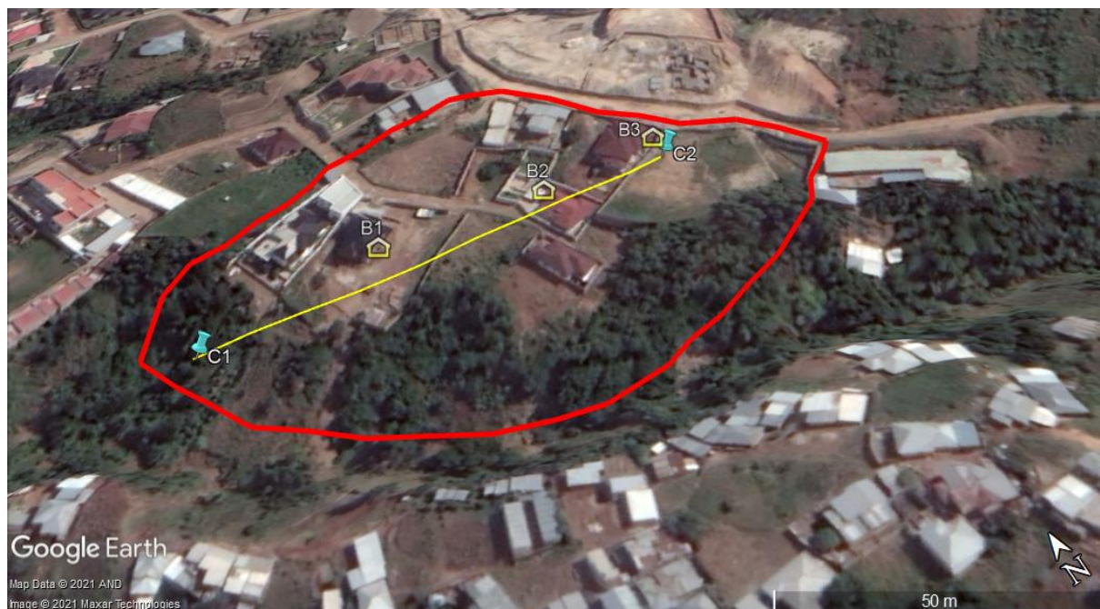
Figure 3-1 : Matérialisation des bâtiments et Plan de coupe pour la modélisation 2D
