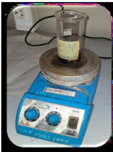
Figure 6 : Montage expérimental utilisé pour l'étude de l'adsorption des polluants sur le charbon actif
