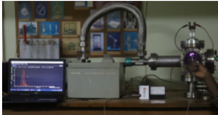
FIGURE 3.2 – Photo de l'installation du montage. De gauche à droite : un ordinateur pour le traitement des données reçues de la part du spectromètre, en couleur blanche à côté de la pompe à vide qui vient tout juste après l'ordinateur et enfin le réacteur que nous avons utilisé.
