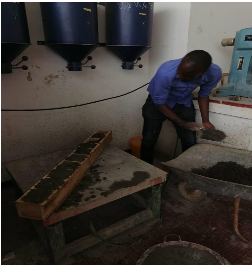
Figure 21. Remplissage des moules.
