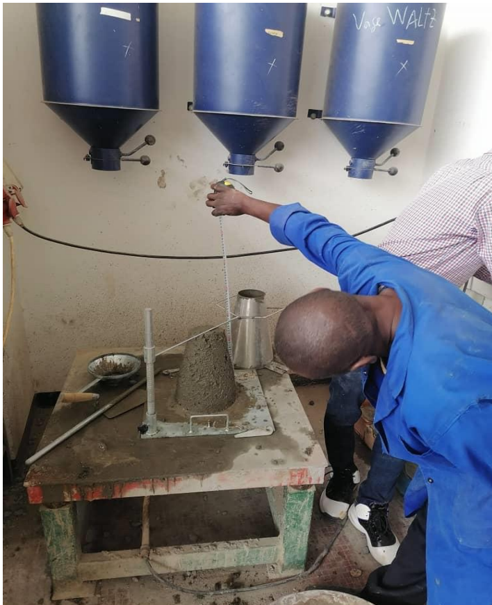
Figure 22. Essai sur l'affaissement.
